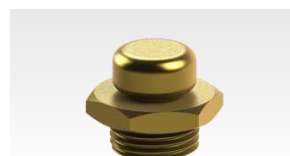
4301 Respiro 3/8" - 19 BSP Comp. Total 20 mm Comp. Rosca 7 mm Tampa Ø 15,5 mm Sextavado 7/8" (22,22mm)
