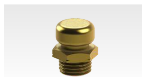
4304 Respiro 1/4" - 18 NPT Comp. Total 20 mm Comp. Rosca 6,5 mm Tampa Ø 15,5 mm Sextavado 5/8" (15,87 mm)
