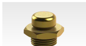
4305 Respiro 3/8" - 18 NPT Comp. Total 20 mm Comp. Rosca 7 mm Tampa Ø 15,5 mm Sextavado 7/8" (22,22mm)
