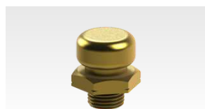
4303 Respiro 1/8" - 28 BSP Comp. Total 19 mm Comp. Rosca 5,5 mm Tampa Ø 15,5 mm Sextavado 9/16" (14,29mm)
