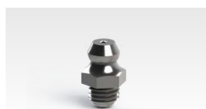
4028 Graxeira M6 x 1 mm Retã Comp. Total 13,3 mm Comp. Rosca 4,8 mm Tipo Retã Sextavado 5/16" (7,94 mm)
