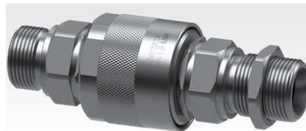
5169 Conj. Engate Rápido Hidr. Compl. 1/2" X M24x1,5 mm (M) Colh. Rosqueado
