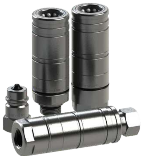
4961 Conjunto Engate Hidr. Agrícola 1/2" X M22x1,5 mm (F) Comp. Total 130 mm Roscas Int. vide na descrição Tipo Completo Chave Macho 1" (25,40 mm) Chave Fêmea 1.3/8" (34,93 mm)
