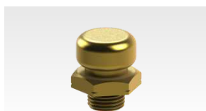
4302 Respiro 1/8" - 27 NPT Comp. Total 19 mm Comp. Rosca 5,5 mm Tampa Ø 15,5 mm Sextavado 9/16" (14,29mm)
