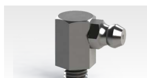
4031 Graxeira M6 x 1 mm 90° Comp. Total 19 mm Comp. Rosca 5,5 mm Tipo 90° Largura 18 mm Sextavado 3/8" (9,52 mm)
