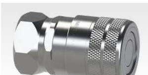
4923 Eng. Hidr. Fêmea 1/2" X 1/2" NPT (F) Face Plana Comp. Total 68,5 mm Rosca Interna 1/2" - 14 NPT Tipo Fêmea Chave 1.1/4" (31,75 mm)
