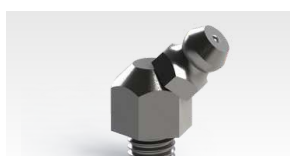
4030 Graxeira M6 x 1 mm 45° Comp. Total 20,3 mm Comp. Rosca 5,5 mm Comp. Corpo 14,5 mm Tipo 45° Largura 15,3 mm Sextavado 3/8" (9,52 mm)
