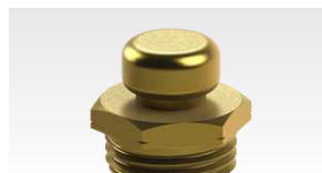
3289 Respiro 1/2" - 14 BSP Comp. Total 20 mm Comp. Rosca 6,5 mm Tampa Ø 15,5 mm Sextavado 7/8" (22,22mm)
