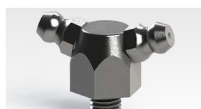
4187 Graxeira M6 x 1 mm Dupla Alimentação Comp. Total 19 mm Comp. Rosca 6 mm Tipo Dupla Alimentação Largura 29 mm Sextavado 1/2" (12,70 mm)
