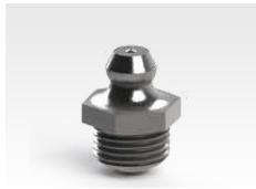
4159 Graxeira M10 x 1.25 mm Reta Comp. Total 15,6 mm Comp. Rosca 5,5mm Tipo Reta Sext. 7/16" (11,11 mm)
