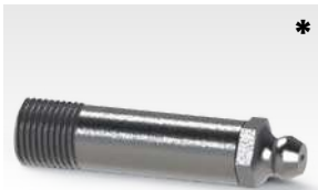
5055 Graxeira M10 x 1 mm Reta 43 mm Comp. Total 43 mm Comp. Rosca 7 mm Corpo Ø9,5 x 34 mm Tipo Reta Sextavado 3/8" (9,53 mm)
