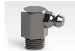
4225 Graxeira M10 x 1.5 mm 90° Comp. Total 19 mm Comp. Rosca 6 mm Tipo 90° Largura 19,6 mm Sext. 7/16" (11,11 mm)
