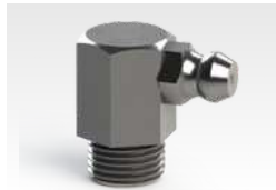
4161 Graxeira M10 x 1.25 mm 90° Comp. Total 19 mm Comp. Rosca 6 mm Tipo 90° Largura 19,6 mm Sext. 7/16" (11,11 mm)
