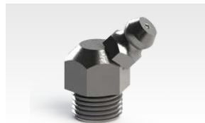
4018 Graxeira M10 x 1 mm 45° Comp. Total 20,3 mm Comp. Rosca 6 mm Comp. Corpo 14,5 mm Tipo 45° Largura 16,5 mm Sextavado 7/16" (11,11 mm)
