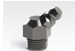
4147 Graxeira M10 x 1.5 mm 45° Comp. Total 20,3 mm Comp. Rosca 6 mm Comp. Corpo 14,5 mm Tipo 45° Larg. 16,5 mm Sext 7/16" (11,11 mm)
