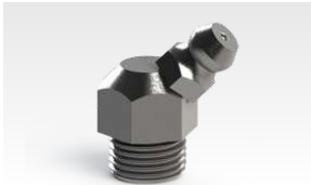
4163 Graxeira 3/8" - 16 UNC 45° Comp. Total 20,3 mm Comp. Rosca 6 mm Comp. Corpo 14,5 mm Tipo 45° Largura 16,5 mm Sextavado 7/16" (11,11 mm)
