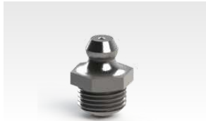
4162 Graxeira 3/8" - 16 UNC Reta Comp. Total 15,6 mm Comp. Rosca 5,5 mm Tipo Reta Sextavado 7/16" (11,11 mm)
