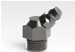
4160 Graxeira M10 x 1.25 mm 45° Comp. Total 20,3 mm Comp. Rosca 6 mm Comp. Corpo 14,5 mm Tipo 45° Larg. 16,5 mm Sext. 7/16" (11,11 mm)
