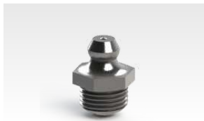
4017 Graxeira M10 x 1 mm Reta Comp. Total 15,6 mm Comp. Rosca 5,5 mm Tipo Reta Sextavado 7/16" (11,11 mm)
