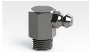
4164 Graxeira 3/8" - 16 UNC 90° Comp. Total 19 mm Comp. Rosca 6 mm Tipo 90° Largura 19,6 mm Sextavado 7/16" (11,11 mm)
